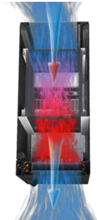
Luftstrom Serverrack m. Vertiv Knürr DCL (Schnittdarstellung)
